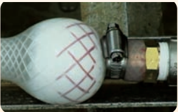
わかりやすいように端面の補強糸を赤く染めています。
